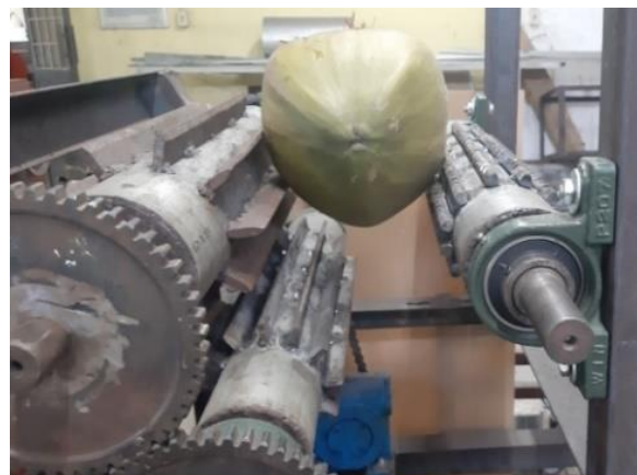
Hình 10. Hệ thống trục răng bố trí thực nghiệm.
