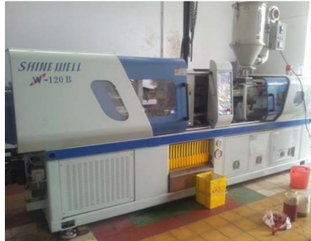
Hình 2. Máy ép phun SW-120B và mẫu thử kéo, uốn
