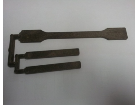
Hình 2. Máy ép phun SW-120B và mẫu thử kéo, uốn
