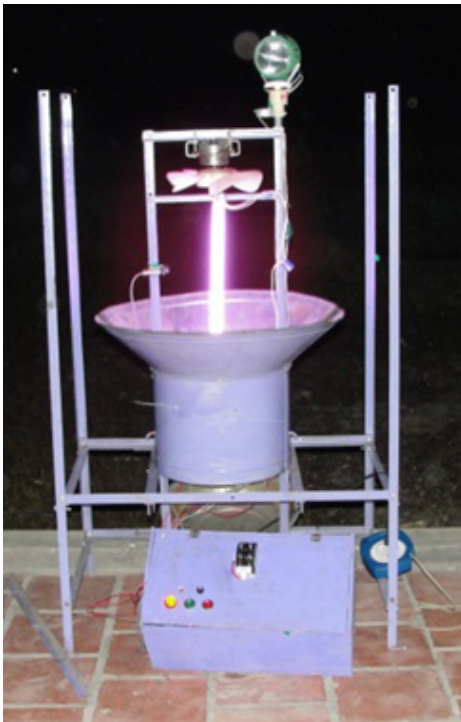
Hình 7: Nguyên mẫu 1 và 2 máy bắt rầy nâu đã chế tạo [10, 11]
