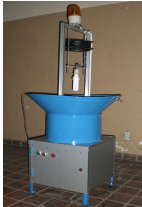
Hình 7: Nguyên mẫu 1 và 2 máy bắt rầy nâu đã chế tạo [10, 11]
