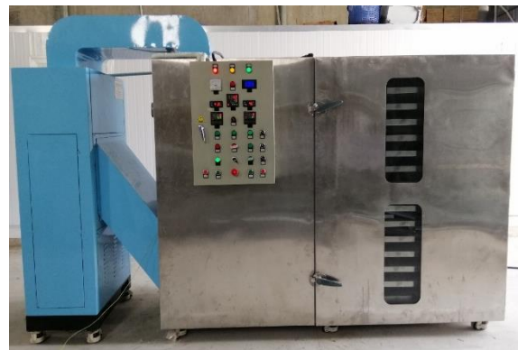
Hình 5. Máy sấy nấm theo nguyên lý sấy bơm nhiệt
