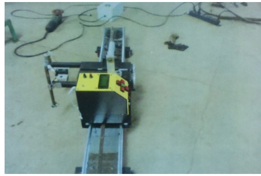
Hình 6: Robot hàn đường thẳng
