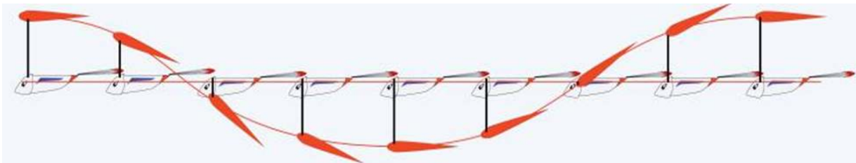
Hình 8. Chuyển động theo hình sin của robot chim.
