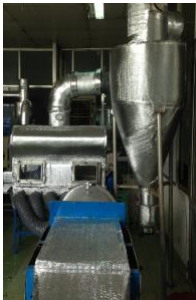
1- Phễu chứa đường RS ẩm; 2- Vít tải nguyên liệu; 3-Buồng sấy tầng sôi; 4- Bộ cấp khí kiểu xung; 5- Bộ gia nhiệt tác nhân sấy; 6- Ống thải khí ẩm; 7- Ống thoát khí ẩm ra khỏi hệ thống sấy; 8- Cyclone; 9- quạt cấp khí tươi vào bộ trao đổi nhiệt
