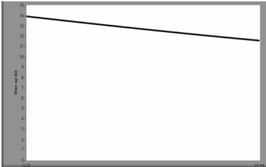
Hình 12. Đồ thị biểu diễn quá trình xả tụ cấp điện cho kim phun
