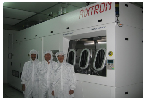
Hình 2. (a) Sơ đồ nguyên lý của phương pháp MOCVD và (b) Thiết bị MOCVD tại khu công nghệ cao TP. HCM (SHTP) [10].
