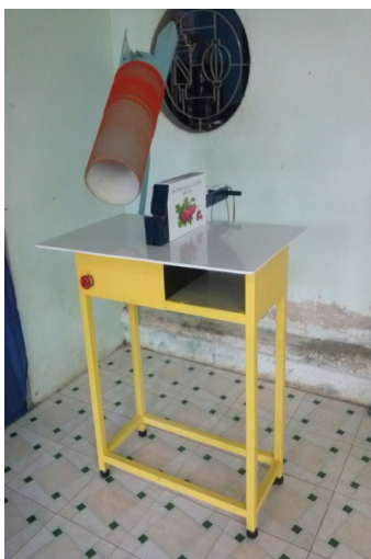
Hình 13: Mô hình kiểm định cơ cấu đóng gói cà chua bán tự động được chế tạo.
