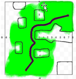
Hình 2a: Kết quả mô phỏng với hệ số lực hút bằng 15
