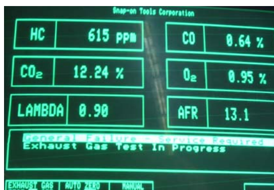
Hình 9: Các thông số khí thải đo khi động cơ chạy cầm chừng
