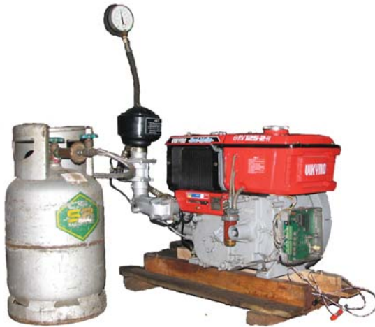
Hình 3: Động cơ VIKYNO sau khi lắp đặt các bộ phận điều khiển phun LPG
