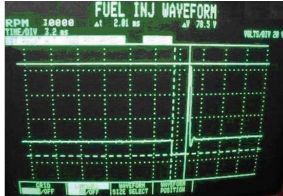
Hình 7: Dạng xung vòi phun khi hiệu chỉnh cực THW (mạch L-Jetronic) bằng cách mắc song song điện trở R_b=0.337 kΩ
