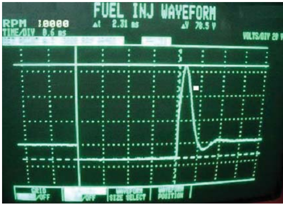
Hình 6: Dạng xung vòi phun mạch L-Jetronic khi chưa tác động điện trở R_b
