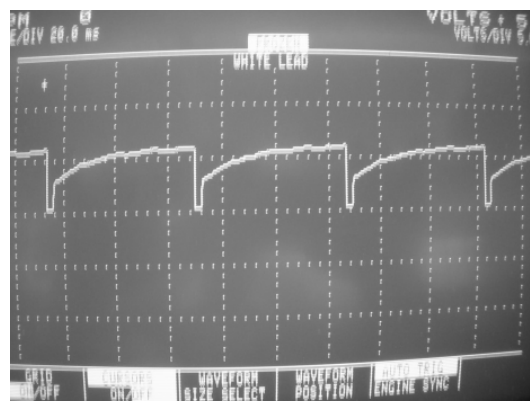
Hình 5: Tín hiệu điều khiển kim phun số 1 (IJN#1)
